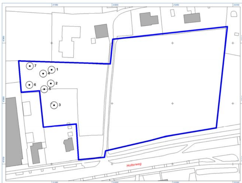
Afb. 1: Overzicht van uitgevoerde boringen
